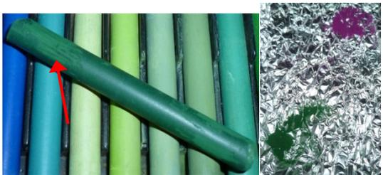
Avec un scalpel ou un tissue blade, prélever et récupérer de la poudre des pastels choisis en grattant avec un scalpel ou un cutter le côté de chaque « bâton » sur un papier d'aluminium.
