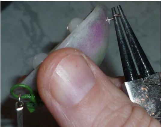
Avec une pince à bouts ronds, recourber le clou (en faisant attention de ne pas abîmer la coupole) ...
