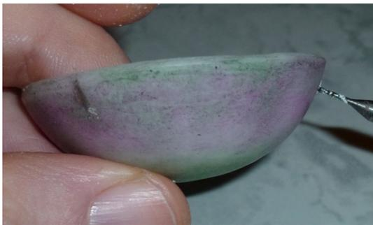
Au minimum à 0,5 cm du bord et sur les 3 marques tracées précédemment, avec un mini-foret, percer un petit trou le plus perpendiculairement possible.
