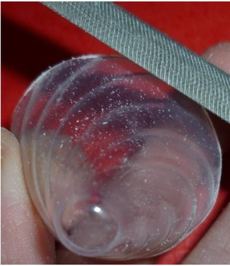
Si besoin, avec une lime plate, limer le bord de votre cône afin de le rendre le plus régulier possible.
