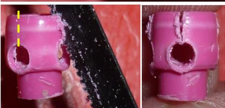
Avec une scie à onglet, scier une fente perpendiculaire à chaque trou, ...
