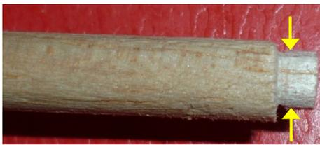
Sur l'une des extrémités (qui est le haut du futur pied du lampadaire), avec une lime plate, sur maximum 0,5 cm, limer afin d'affiner le diamètre de celle-ci.
