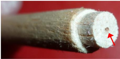
Avec le plus petit foret (ou avec l'épingle à couture) percer un trou au centre de cette même extrémité. Il est important de percer ce trou perpendiculairement.
