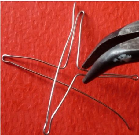
Avec une pince à recourber, rapprocher les fils de fer de l'une des branches de l'armature, comme ceci.
