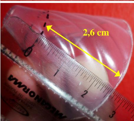
Avec un feutre indélébile (pour CD), à intervalle régulier, marquer le cône à la hauteur désirée, ici à 2,6 cm du bord inférieur.
