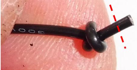
Faites un nœud à l'extrémité du fil électrique (partie qui dépasse sous le luminaire), et coupez l'excédent.
