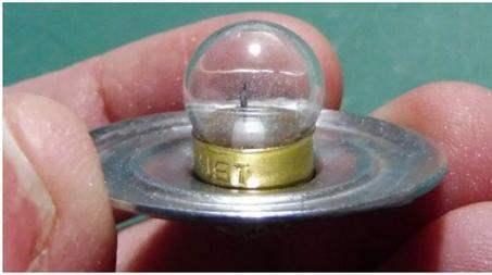
On vérifie que l'ampoule passe bien au centre du luminaire, et que celle-ci pourra donc être enfoncée en son centre, afin d'y être collée.
