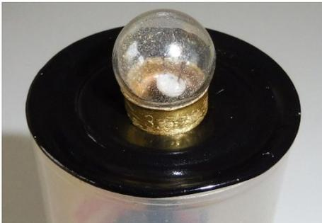
Sans attendre que la colle sèche complètement, insérez l'ampoule le plus droit possible, tout en veillant à ne pas l'enfoncer complètement. Puis laissez sécher suffisamment longtemps.
