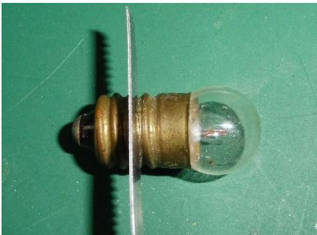
On va maintenant raccourcir notre ampoule dont le corps risque d'être trop grand/allongé pour tenir sous l'ensemble « rosace/joint/clochette ». Pour ce faire, avec une petite scie à main ou une scie de précision, sciez la partie métallique de votre ampoule juste après le premier pas de vis ...
