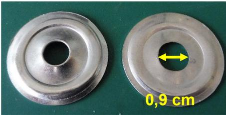
Rosace d'origine à gauche, à côté de la rosace dont le trou a été agrandi (à droite) suffisamment pour laisser passer l'ampoule. Pour le type d'ampoule choisie, le diamètre du trou doit être de  $\pm 0,9$  cm.
