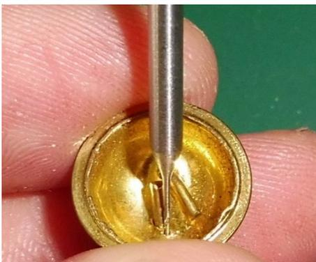
Pour plus de réalisme, en vue de pouvoir insérer un fil électrique jusqu'à l'ampoule de notre luminaire, il va falloir creuser un passage pour ce dernier. **2 méthodes :** soit agrandir l'un des trous où passe l'accroche de la clochette, soit percer un trou au milieu de la clochette (entre les 2 trous de l'accroche).
